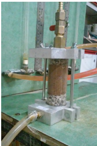
شکل ۶. نمونه مورد آزمایش در سلول نفوذپذیری
