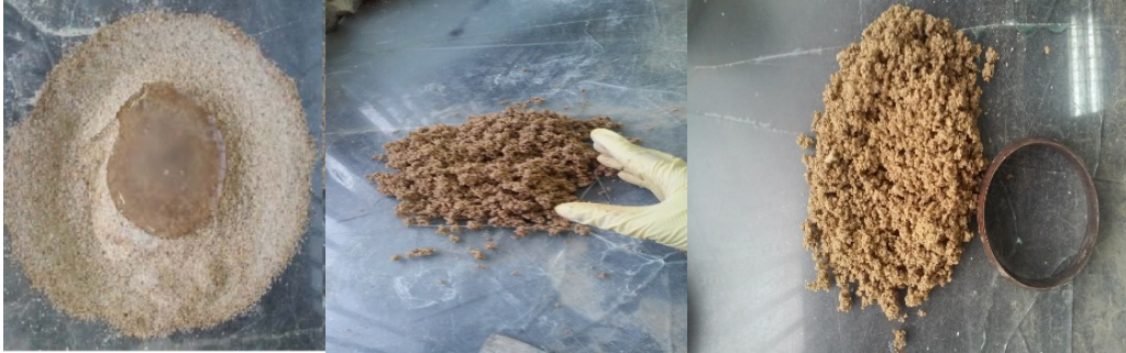
شکل ۴. آماده سازی نمونه برای آزمایش برش مستقیم
