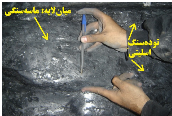
شکل ۱۰. وجود میان لایه‌های ماسه‌سنگی در توده سنگ اسلیتی.
