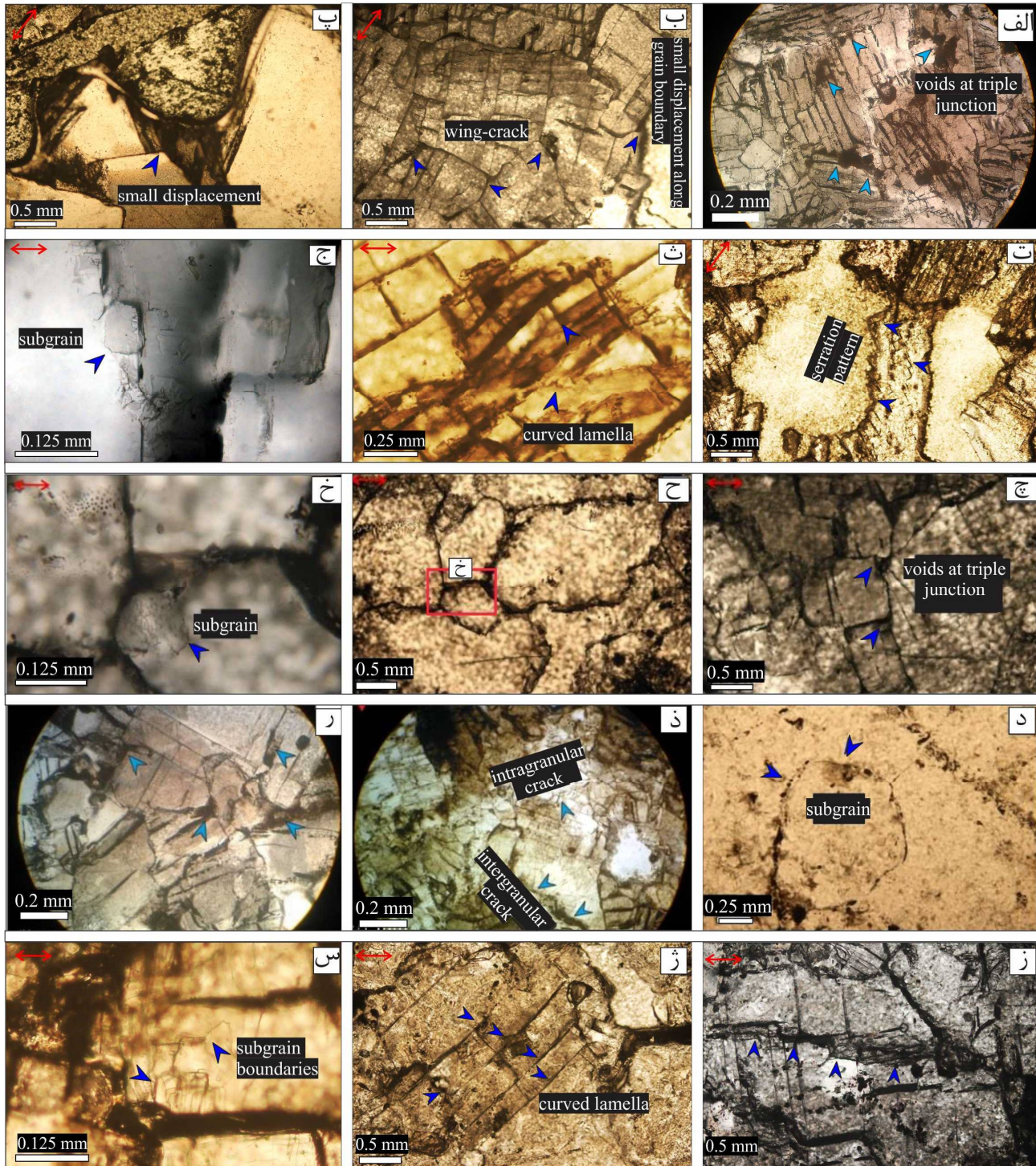
شکل 9. ریزساختار ایجاد شده در نمونه‌های نمکی بعد از آزمون‌های مکانیکی.
