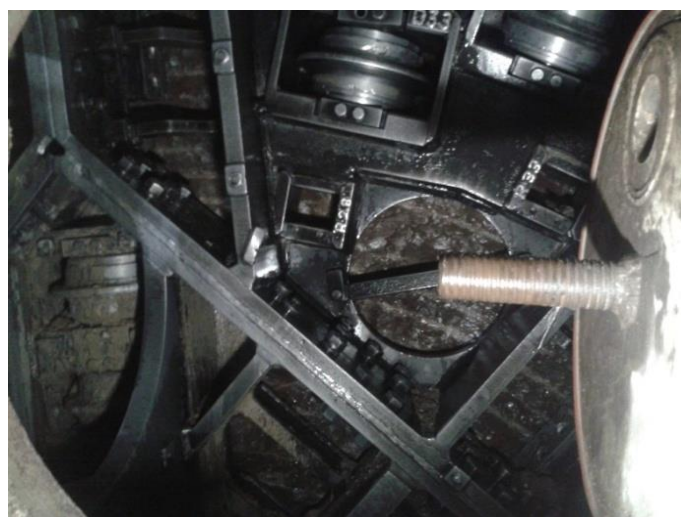
شکل ۸. دید از دریچه عینکی چمبر- متراژ ۳۳۸۷، نمایی از استحکام و بالا بودن پارامترهای ژئومکانیکی توده سنگ شیل آهکی (کاهش نرخ نفوذ تا ۱۸ میلی متر بر دور، افزایش تراست نیز تا میزان ۱۰۳۵ تن، کاهش نیروی گشتاور تا میزان ۱۳۰ تن متر).
