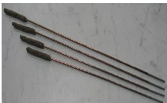
شکل ۳. مهارهایی به طول ۴۰، ۳۷، ۳۴ و ۴۳ cm و قطر ۳ mm استفاده شده در مدل سازی که انتهای آن‌ها حدیده شده است.
