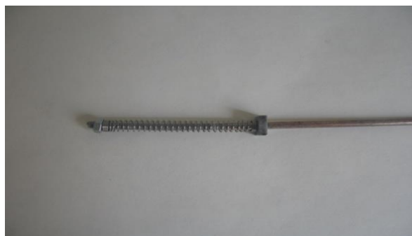
شکل ۴. اجزای سر مهار شامل فنر، مهره و واشر که در مدل استفاده شده است که از واشر به عنوان صفحه باربر و فنر برای پیش تنیده کردن مهارها استفاده شده است.
