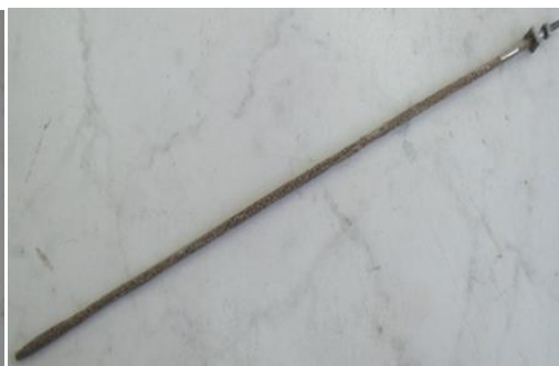
شکل ۲. میخ به طول ۳۰ cm و قطر نهایی ۴ mm استفاده شده در مدل سازی به همراه مهره و واشر که بعنوان صفحه باربر در نظر گرفته شده است.
