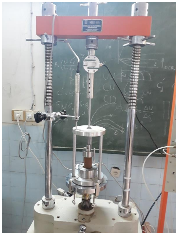
شکل ۷. سیستم توسعه داده شده برای انجام آزمایش مقاومت کششی تک محوری مستقیم
