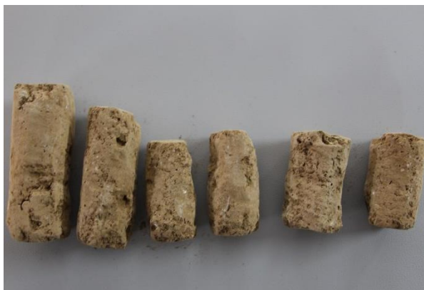
شکل ۴. نمونه‌های دست نخورده استوانه‌ای شکل خاک ۱ که به روش برش دستی تهیه شده‌اند
