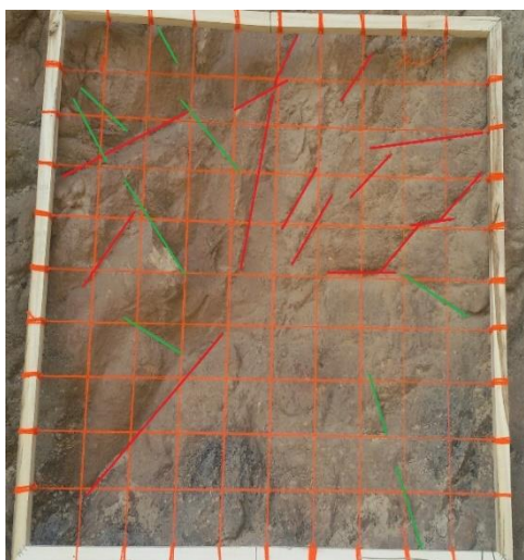
شکل ۷. اندازه‌گیری چگالی درزه‌داری سطحی (P 20 ) با استفاده از پنجره مشبک
