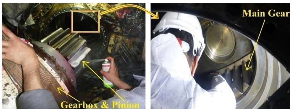
شکل ۱۶. محل اتصال چرخ‌دنده خروجی گیربکس‌ها به چرخ‌دنده یاتاقان اصلی*.
