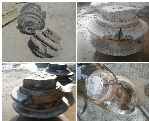
شکل ۶. شکستگی دیسک‌های برشی دوبل (دو تیغه).
