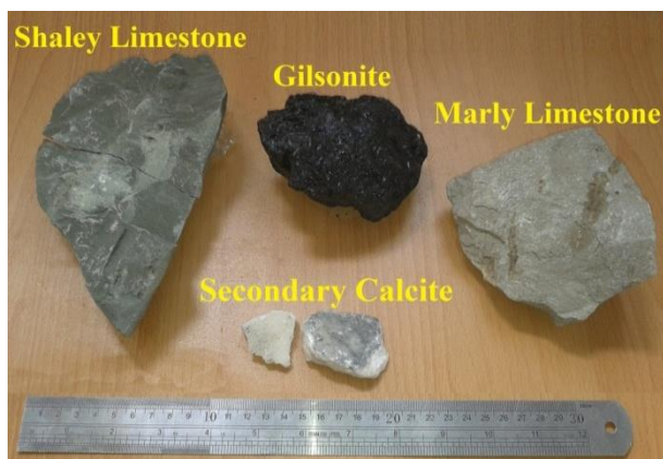
شکل ۱۹. اندازه مصالح حفاری در موقعیت توقف دستگاه.
