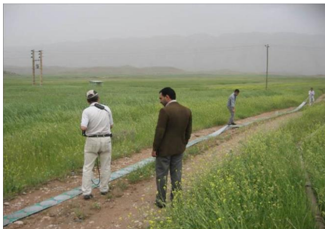
شکل ۴. انجام عملیات ژئوفیزیکی به روش رادار نفوذی زمینی (GPR) با آنتن‌های کششی ۱۰ مگا هرتزی در منطقه دشت جایدر.
