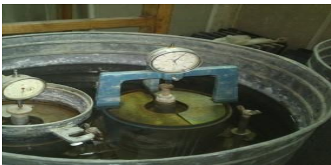
شکل ۸. طریقه اندازه گیری تورم نمونه های CBR
