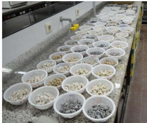
شکل ۳. تعدادی از نمونه‌های آماده‌سازی شده برای تعیین شاخص شکنندگی S20.
