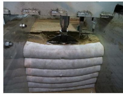
الف - تغییر شکل رویه مدل و نشست پی؛ نما از روبرو
