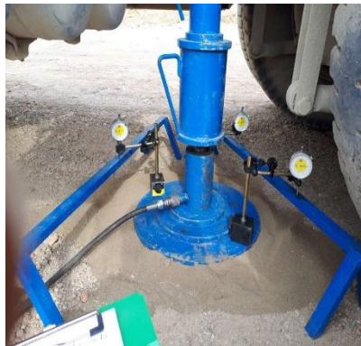
شکل ۳. انجام آزمایش بارگذاری صفحه ای بر روی خاکریز آزمایشی اجرا شده با نخاله‌های ساختمانی
