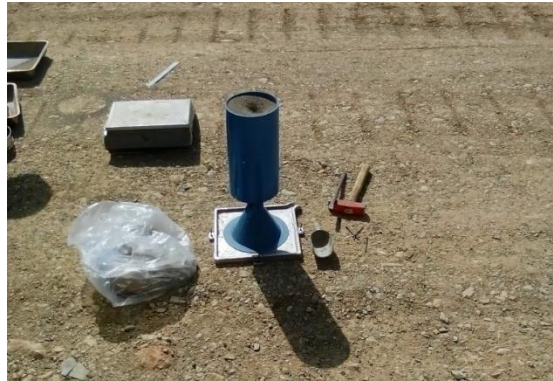
شکل ۲. انجام آزمایش دانسیته در محل بر روی خاکریز آزمایشی اجرا شده با نخاله‌های ساختمانی
