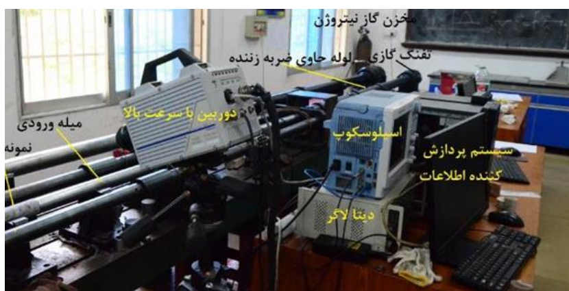
شکل ۱. تجهیزات مورد استفاده در آزمون مقاومت فشار تک محوری استاتیکی
