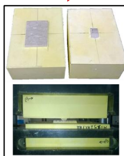
شکل ۱. دستگاه آزمایش برش مستقیم خودکنترل و انواع نمونه‌های مورد آزمایش (آزمایشگاه مکانیک سنگ دانشگاه ملی سئول).
