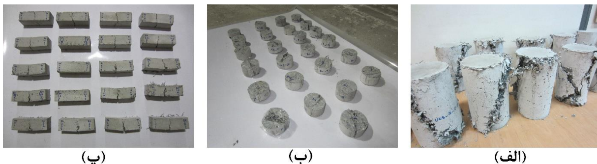
شکل ۵. نمایی از نمونه‌ها بعد از انجام آزمایش (الف) مقاومت فشاری تک محوره، (ب) برزیلی، (پ) خمش سه نقطه‌ای
