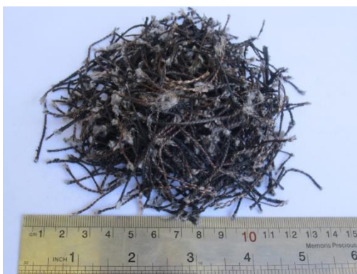
شکل ۲. الیاف مورد استفاده در شاتکریت
