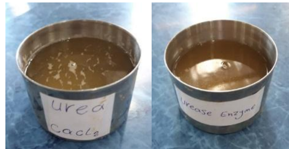
شکل ۷. محلول آنزیم اوره آز (سمت راست)، محلول اوره و کلسیم کلراید (سمت چپ)
