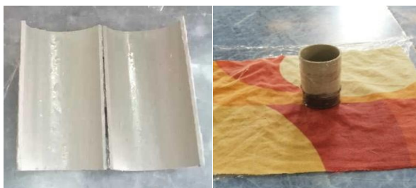
شکل ۶. قالب های PVC جهت ساخت نمونه
