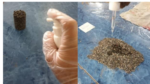
شکل ۸. نحوه تزریق محلول‌های آنزیم اوره آز و کلسیم کلراید و اوره (سمت راست)، اسپری نمودن محلول‌ها پس از ۲۴ ساعت (سمت چپ)
