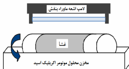
شکل ۳: سیستم تابش اشعه ماوراء بنفش بر سطح غشا به منظور اصلاح آن.
