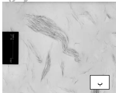
شکل ۷: تصاویر میکروسکوپ الکترونی عبوری مربوط به: الف) نمونه ۳٪ MMT و ب) نمونه ۵٪ MMT.
