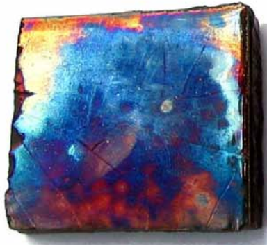
شکل ۳: تصویر سطح لعاب احیا شده RCG.
