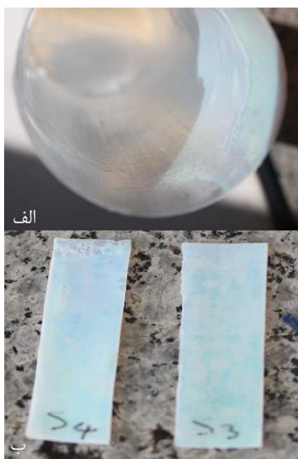
شکل ۵: یک پیش‌ساخته ۷ لایه‌ای (شکل الف) و همچنین فیلم‌های ۴ و ۷ لایه‌ای (شکل ب از راست به چپ).
