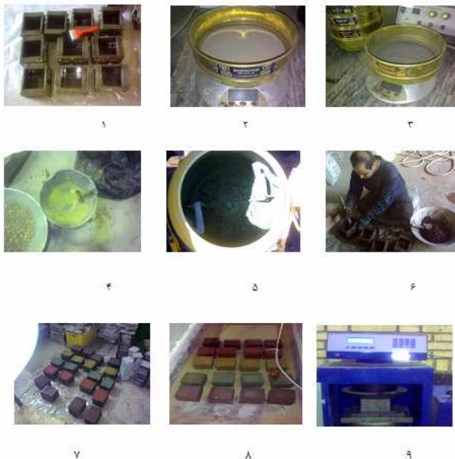
شکل ۱: آماده‌سازی نمونه‌ها و تعیین مقاومت فشاری آن‌ها.
