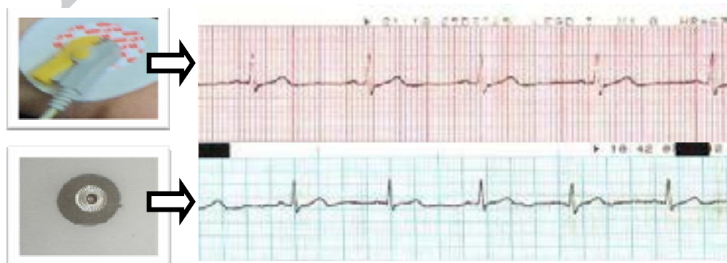
شکل ۱۳: ردیف بالا الکتروانعطاف‌پذیر و پیام دریافتی از آن و ردیف پایین حسگر چاپی دایره‌ای شعاع ۱ سانتی‌متر و سیگنال دریافتی آن.
