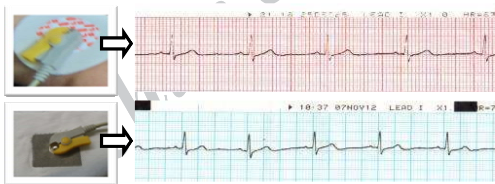
شکل ۱۲: ردیف بالا الکتروانعطاف‌پذیر و پیام دریافتی از آن و ردیف پایین حسگر چاپی ۳×۳ و سیگنال دریافتی آن.
