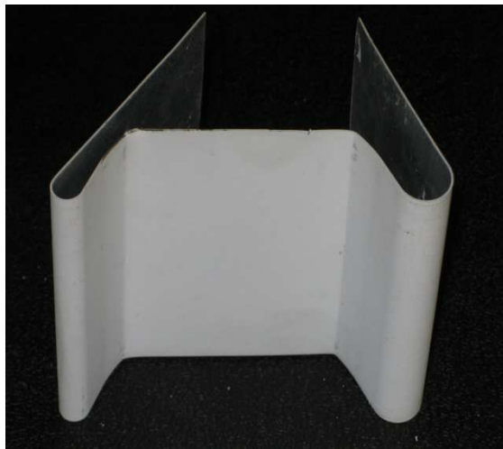
شکل ۹: تصویر از سطح نمونه D (رنگ با نسبت رنگدانه به رزین ۳:۱) پس از انجام آزمون خمش.
