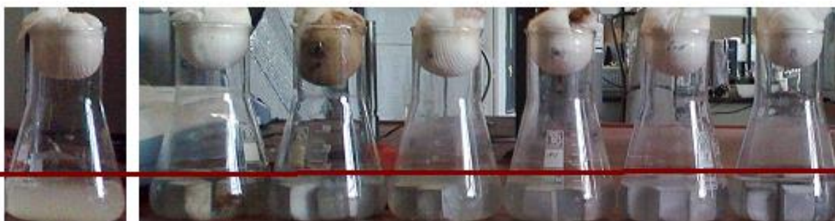
شکل ۵: تصاویر بررسی چشمی کدورت محلول انواع آزمایش‌های بررسی سمیت نانوذرات دی‌اکسید تیتانیوم تثبیت شده در بستر سیمان. شاهد سیمانی بدون باکتری و نانوذرات، شاهد سیمانی ۱٪ نانوذرات و بدون باکتری، ۰٪، ۰٫۱٪، ۰٫۵٪، ۱٪ شاهد بدون نمونه سیمانی
