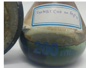
شکل ۱: تصویر نمونه کامپوزیت اکسید آهن-اکسید مس و رفتار مغناطیسی تحت میدان آهن‌ربا.
