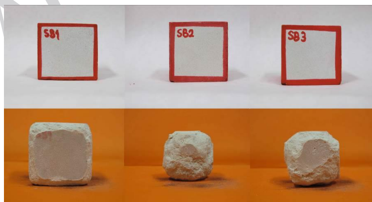
شکل ۱: مکعب‌های بالا: نمونه‌های معدن الماس‌بری قبل از پیرسازی تسریعی، مکعب‌های پایین: همان مکعب‌ها پس از ۷۰ چرخه پیرسازی تسریعی با سدیم سولفات.
