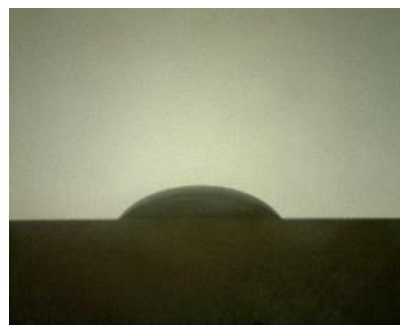
شکل ۱۲: تصویر سمت راست) عکس برداری از قطره توسط میکروسکوپ داینو و تصویر سمت چپ) تصویر دوتایی شده توسط روش اتسو.
