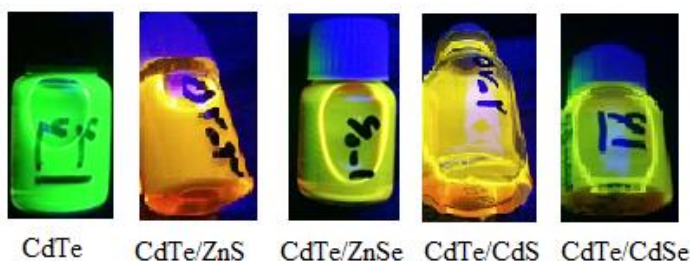
شکل ۱۰: تصاویر سوسپانسیون کلئیدی نقاط کوانتومی CdTe قبل و بعد لایه نشانی پوسته‌های ZnSe, CdS, ZnSe و CdSe با زمان تقطیر برگشتی یک ساعت تحت تابش فرابنفش.
