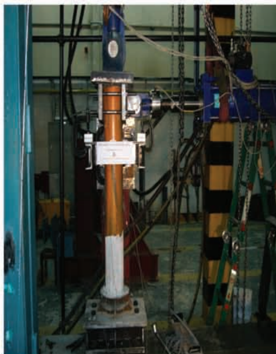
شکل (۷): دستگاه آزمایش نمونه های CFST
