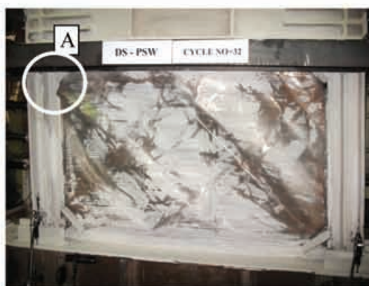
شکل (۴): تغییر شکل نمونه آزمایشگاهی دیوار برشی فولادی با سخت کننده در تغییر مکان ۶۱/۸ میلیمتر
