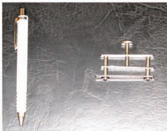
شکل (۹): سیستم بست قابل تنظیم در نمونه سوم میراگر
