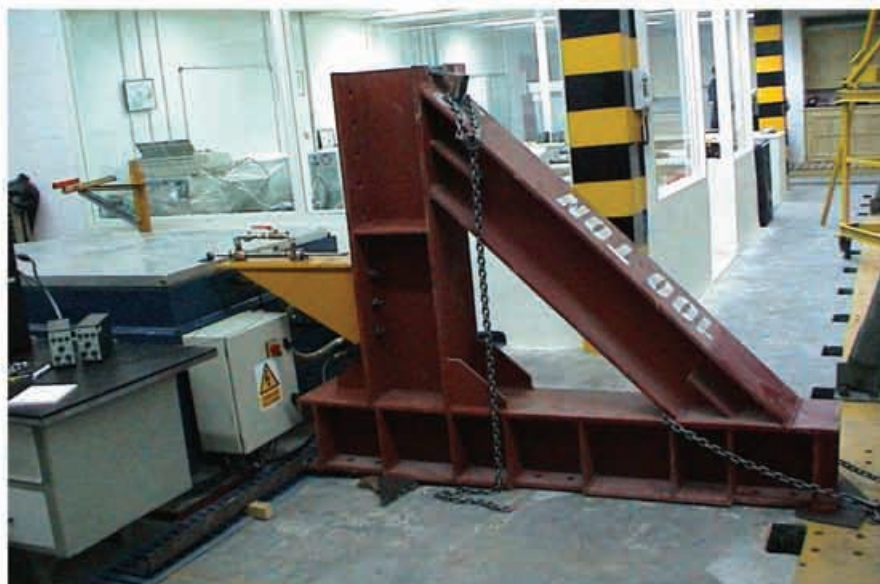
شکل (۴): نحوه اتصال میراگر به میز لرزان
