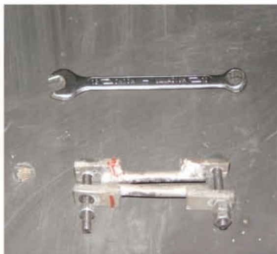
شکل (۱۴): مکانیزم تنظیم جریان روغن
