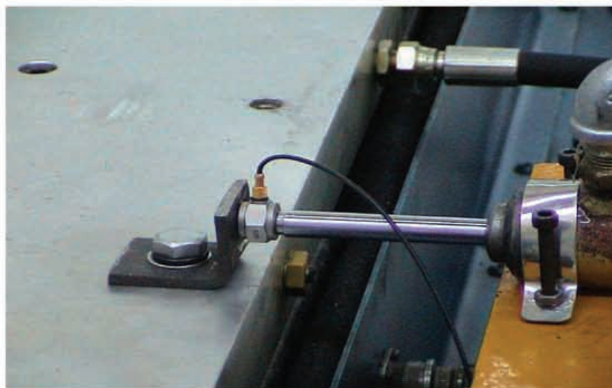
شکل (۵): نحوه اتصال میله میراگر به میز لرزان از طریق نبشی
