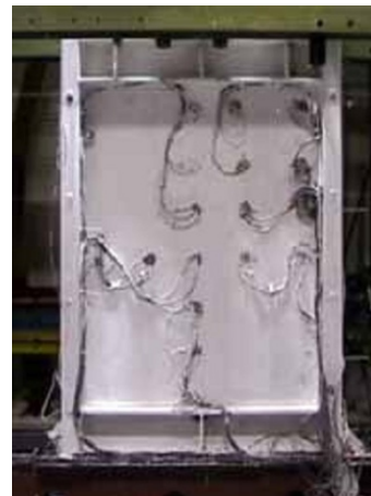
شکل (۱۰): جزئیات نمونه‌های آزمایشی دیوار برشی فولادی شکل پذیر یک طبقه DSW-1 و DSW-2 [۱۸]
