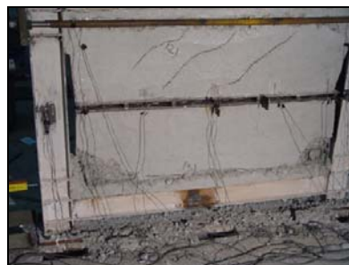
الف- شکست برشی میانقاب به موازات تیر بالا و پایین
