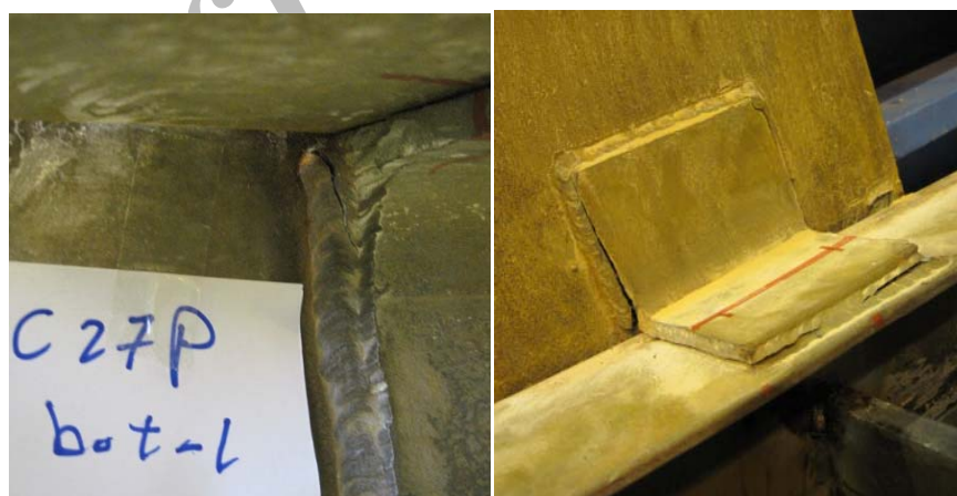
شکل (۶): تصاویری از شکستهای مشاهده شده در نمونه T1
