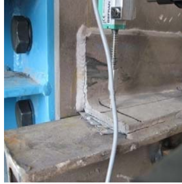
شکل (۱۰): تصاویری از شکستهای مشاهده شده در نمونه T3
