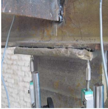
شکل (۱۰): تصاویری از شکستهای مشاهده شده در نمونه T3
