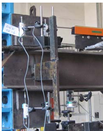
ب: چگونگی اندازه‌گیری دوران در اتصال
