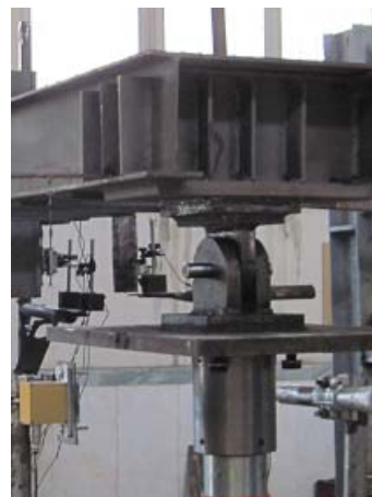
الف: مفصل استفاده شده در نقطه اعمال نیرو
