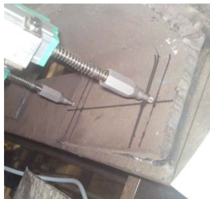
شکل (۸): تصاویری از شکستهای مشاهده شده در نمونه T2
