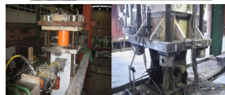
شکل (۴): نحوه اعمال نیروی محوری در نمونه‌ها.
