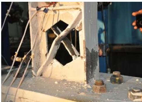
شکل (۱۷): نمایش نحوه تغییر شکل نمونه شماره ۳ (CL3-D.S)
