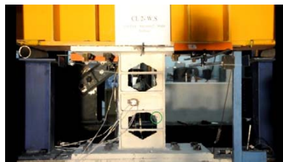
شکل (۱۵): نمایش اولین گسیختگی جان نمونه شماره دو (CL2-W.S)
