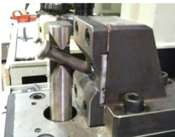
شکل (۷): خمش گلمیخ جوش داده شده با استفاده از دستگاه تست خمش هیدرولیک با اعمال نیرو تحت زاویه 30^\circ درجه نسبت به محور قائم بر صفحه
