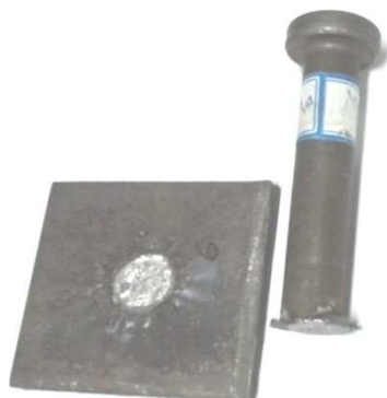
الف) نمونه‌ای که عمق جوش کم است، شکست از فلز جوش اتفاق افتاده است.
