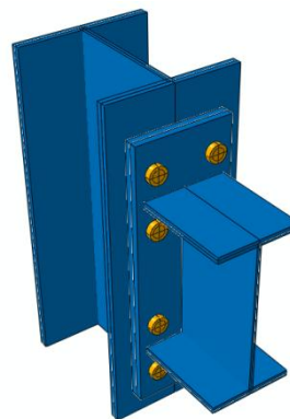
شکل (۲): اتصال خمشی با ورق انتهایی بلند
