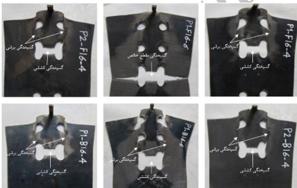
شکل ۶- مسیر شکست نمونه‌های آزمایش
