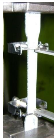
الف) نمونه در دستگاه آزمایش (ب) باریک شدگی و گسیختگی نمونه
