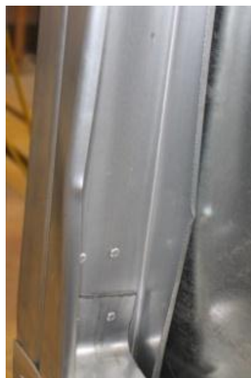
شکل ۵- کمانش موضعی ستونک
