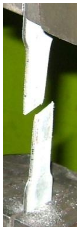
الف) نمونه در دستگاه آزمایش (ب) باریک شدگی و گسیختگی نمونه
