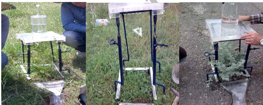
شکل ۲- آزمایش شبیه‌ساز باران در سه فرم رویشی به ترتیب از راست به چپ: فرم رویشی بوته‌ای‌ها، پهن برگ و گندمیان
