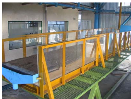
شکل (۱) نمایی از فلوم شیب‌پذیر شبیه‌ساز باران مرکز تحقیقات حفاظت خاک و آبخیزداری
