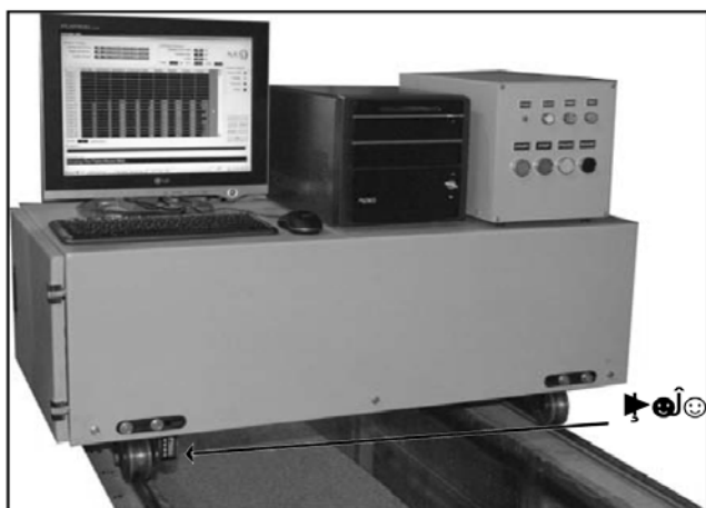
شکل ۲- نمایی از دستگاه برداشت پروفیل بستر لیزری
