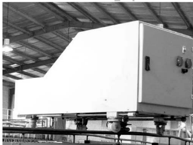
شکل ۱- دستگاه bed profiler و نحوه قرارگیری بر فلولم آزمایشگاهی جهت اندازه‌گیری توپوگرافی بستر
