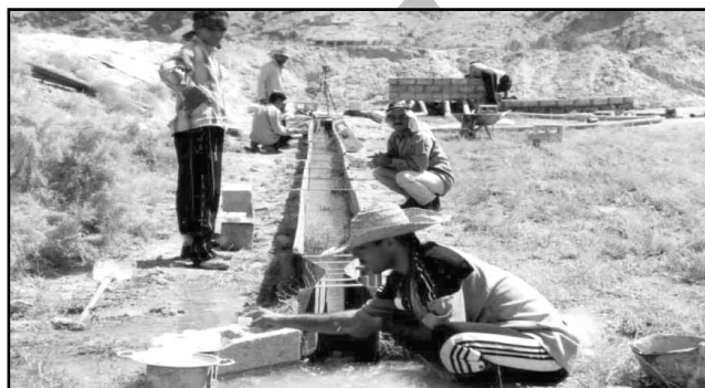
شکل ۱- فلوم راه اندازی شده جهت اندازه‌گیری پارامترهای هیدرولیکی و رسوب
