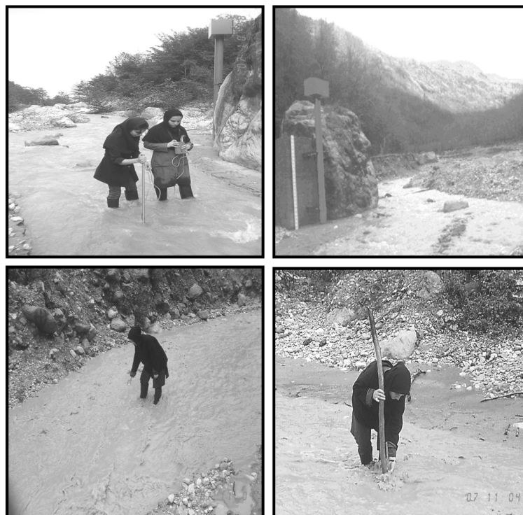
شکل ۲- نمایی از محل اندازه گیری در حوزه آبخیز مورد مطالعه (راست و بالا) و مراحل اجرایی اندازه گیری سرعت جریان با مولینه (چپ و بالا)، تعیین تراز آب (راست و پایین) و نیز برآورد سرعت آب با توپ تنیس روی میز (چپ و پایین)
