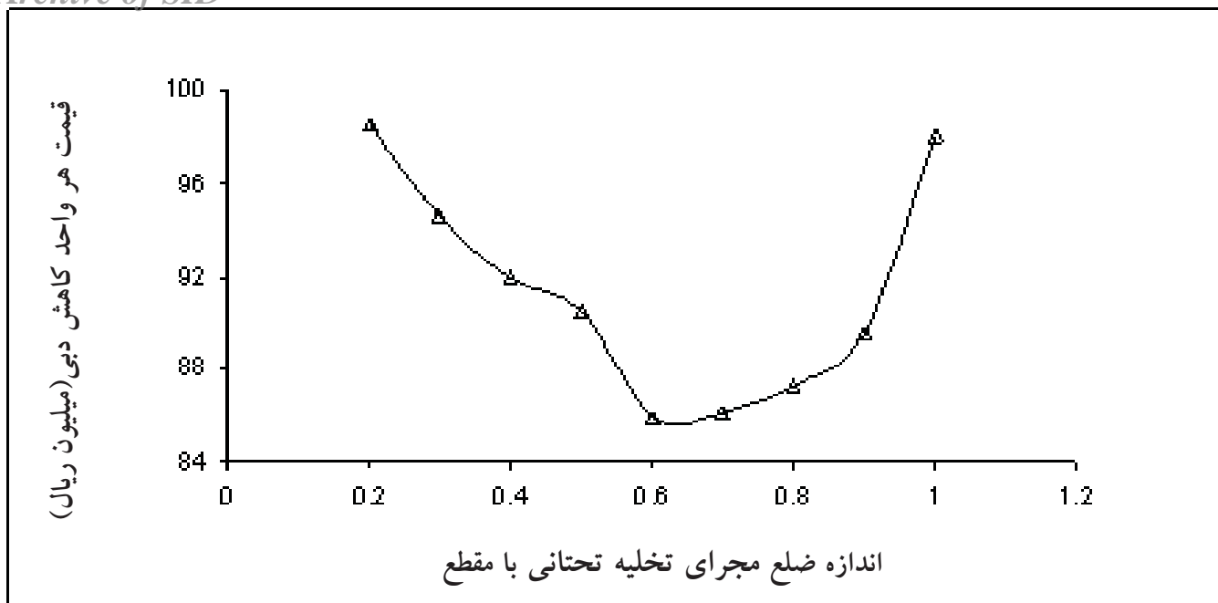
شکل (۳) - اندازه ضلع بهینه شده مجرای تخلیه تحتانی مربع شکل سد تأخیری
