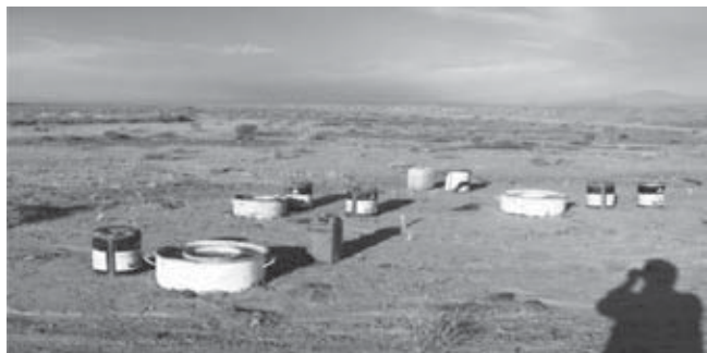
شکل ۲- نمایی از نحوه نصب استوانه‌های مضاعف برای اندازه‌گیری نفوذپذیری
