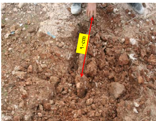
شکل ۲. منطقه مومسان و ترک‌های شعاعی ناشی از انفجار تک‌چال در توده گلسنگی سد گتوند علیا.
